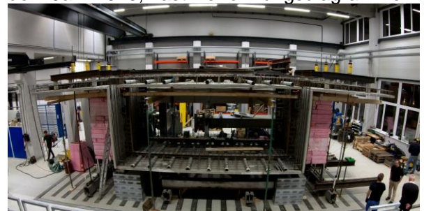
Abb.20: Belastungsversuch der Deckplatte an dem neu gebauten Prototyp
