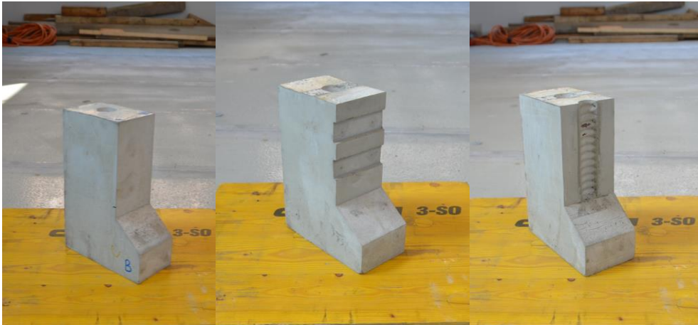
Abb.30: Glatte Oberfläche, Schubnocken, Fuge mit profilierter Nut
