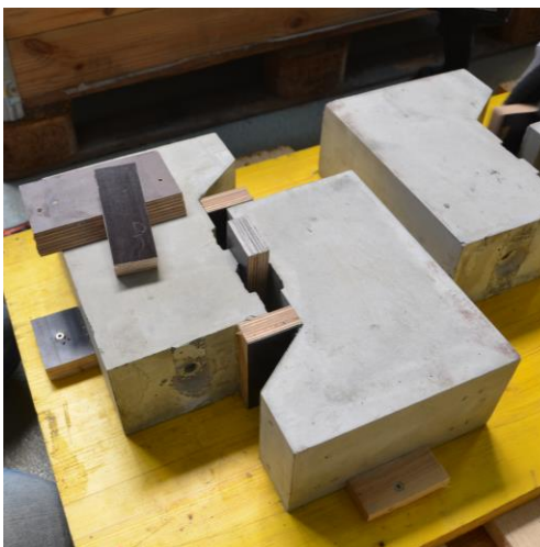
Abb.31: Fugenherstellung bei Versuchskörpern
