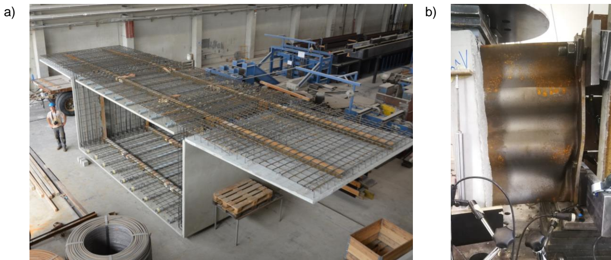
Abbildung 2: a) Brückensegment aus dünnwandigen Fertigteilen; b) Schubversuch an einer dünnwandigen Betonplatte mit einem Stahlträger
