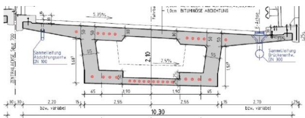
Abb.37: Querschnitt der ausgeführten Brücke
